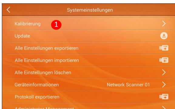
Die neu ermittelten Parameter werden dann im Gerät gespeichert. Um den Kalibrierungsvorgang zu starten, legen Sie das im Lieferumfang enthaltene Kalibrierungsblatt in die Dokumentenvorlage des Gerätes ein und wählen **STARTEN** ②. Der Vorgang wird automatisch gestartet und das Dialogfeld schließt sich nach Abschluss des Vorgangs.
