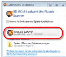
2. Klicken Sie im [Automatische Wiedergabe] Fenster auf [install.exe ausführen]. Wenn die Installation nicht automatisch startet, durchsuchen Sie ihr DVD-ROM-Laufwerk und führen Sie manuell die Datei [install.exe] aus. Klicken Sie auf die Schaltfläche [Ja] falls der Dialog [Benutzerkontensteuerung] auftauchen sollte.
