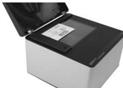
4. El escáner comienza a escanear inmediatamente. Una vez que se ha completado el proceso de escaneado, el escáner emitirá un sonido y el indicador del escáner parpadeará una vez. La imagen escaneada se mostrará en la pantalla.
