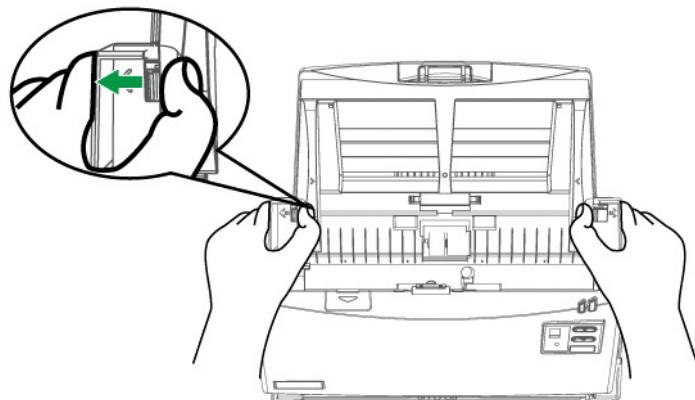
3. 移除進紙滾輪，從兩側向內擠壓進紙滾輪的兩邊固定軸承以將其拉出拿下。
