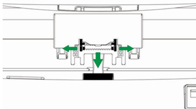
2. 將輔助架上的卡勾裝入橡膠摩擦輪模組上對應的孔中，即可安裝輔助架。
