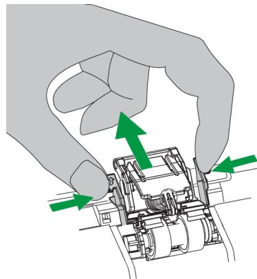
3. 安裝新的橡膠摩擦輪模組，將橡膠摩擦輪模組上的卡勾裝入掃描器上對應的孔中，即可換好新的橡膠摩擦輪模組。
