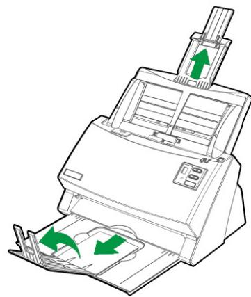
3. 根據紙張寬度調整邊匣的寬度，輕推邊匣使其正好與紙張接觸即可。
