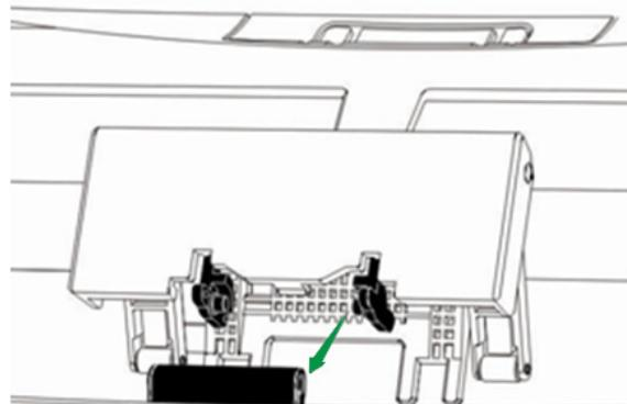
請拉動輔助架兩側的支撐架輕輕地取下輔助架，
