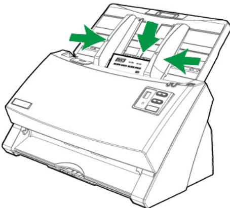
2. 調整紙張寬度調整邊匣到卡片寬度，輕推邊匣使其輕輕觸碰卡片兩邊即可。
