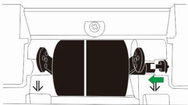
4. 安裝新的進紙滾輪，將進紙滾輪對準裝在掃描器的滾輪連接桿上，即可換好新的進紙滾輪。
