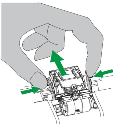
3. Instale el nuevo módulo de rodillo a a fricción insertando las lengüetas en sus receptáculos correspondientes.
