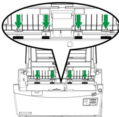
3. Cierre la carcasa del ADF empujándola hacia abajo hasta que se cierre correctamente en su sitio.
