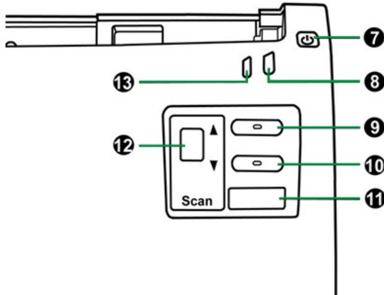
7. BOTÓN DE AHORRO ENERGÉTICO—Presione por 0,5 segundos para ingresar a modalidad standby y presione nuevamente para reactivar el escáner.
