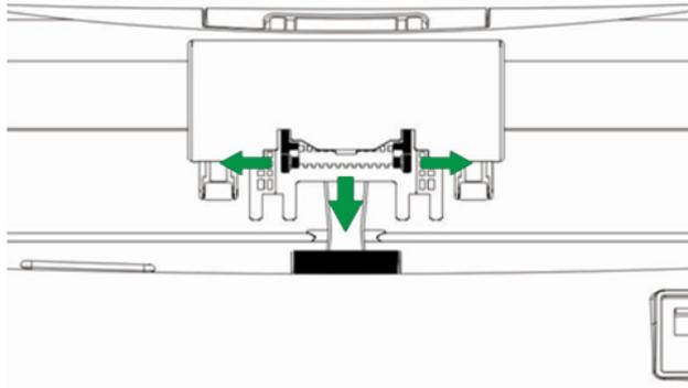
2. Instale el alimentador insertando los sostenedores en los receptáculos correspondientes en el módulo de rodillos.
