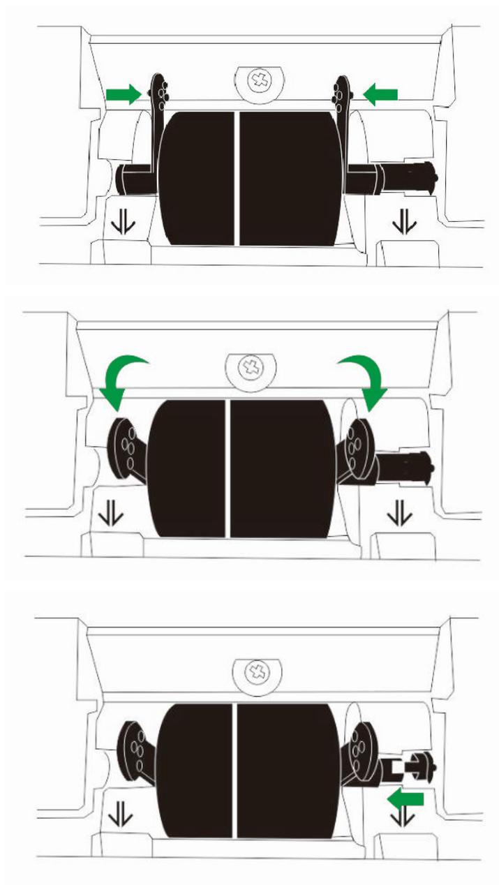
4. Instale el nuevo rodillo alineando e insertando el rodillo de alimentación en la posición indicada en el escáner.
