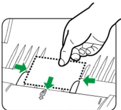
2. Ajuste la anchura del panel a la de la tarjeta de visita, de forma que la guía de anchura toque ligeramente ambos lados de las tarjetas.
