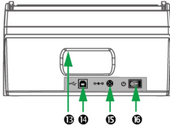
13. APOYAMANOS—Diseñado ergonómicamente para que pueda transportar el escáner con facilidad.
