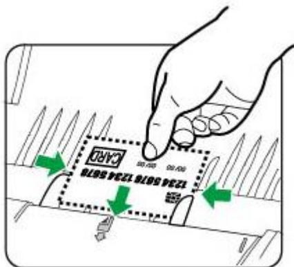
5. Ajuste el papel con el deslizador al ancho de la tarjeta. El deslizador de ancho del papel debería tocar suavemente ambos lados de la tarjeta.
