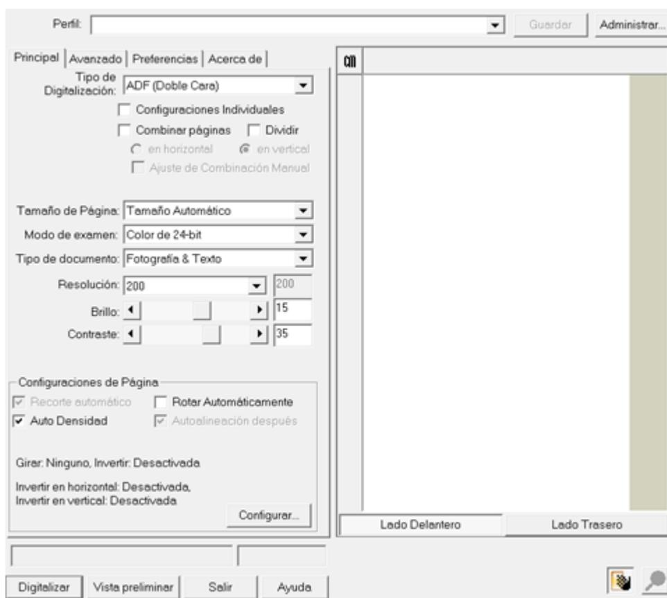
4. Ajuste la configuración de escaneado. Para el escaneado **ADF (Doble Cara)**, puede ajustar la configuración separadamente para cada cara de la tarjeta de visita. Haga clic en el botón **Lado Delantero** para ajustar la configuración de escaneado del lado frontal; posteriormente haga clic en el botón **Lado Trasero** para ajustar la configuración de escaneado por dicha cara.
