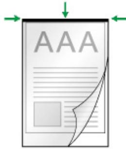
6. Cargue la hoja protectora en el escáner, y alinee la hoja protectora con la línea negra hacia el centro del ADF.
