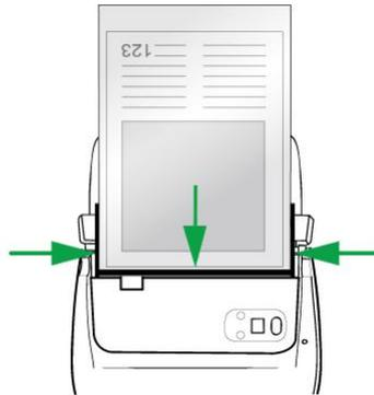
7. Para escanear por una sola cara, coloque hoja de protección hacia abajo.
