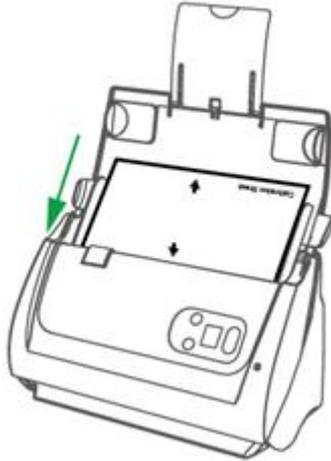
12. Siga las instrucciones que aparecen en pantalla para realizar la calibración. Cuando la calibración haya terminado, haga clic en **OK** y luego haga clic en **Finalizar**.
