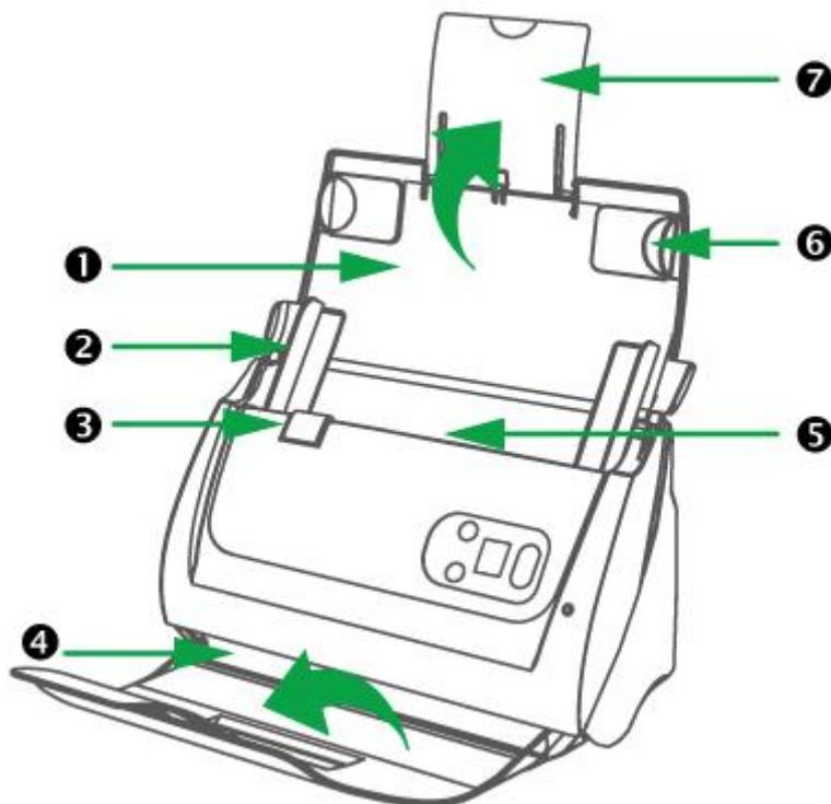
1. TAPA DEL CANAL DE PAPEL—Ayuda a fijar la posición del papel. Abre tapa del canal de papel cuando se utiliza el escáner.
