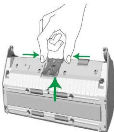
3. Coloque la nueva almohadilla insertando las pestañas del módulo en las ranuras del escáner.
