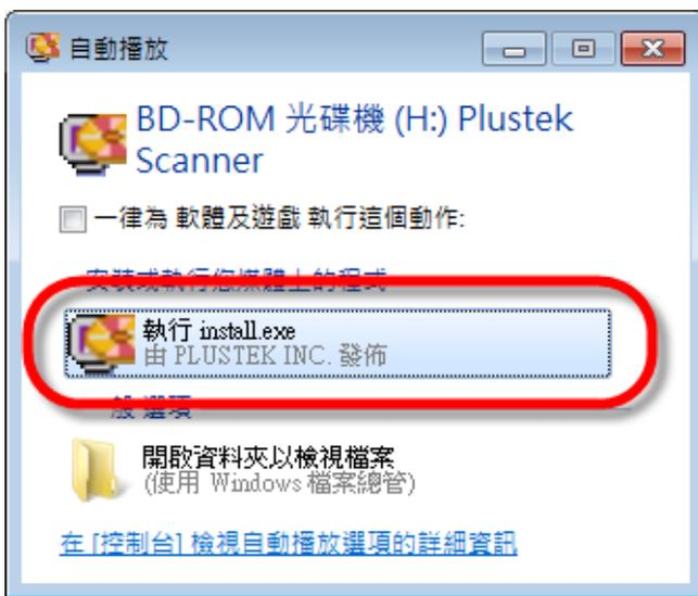
1. 請將隨機附贈的安裝設定軟體光碟片放入光碟機內，在隨後出現的[自動播放]視窗中點擊[執行 install.exe]。如果安裝無法自動啟動，瀏覽您的光碟機並手動執行[install.exe] 執行檔。如果[使用者帳戶控制]對話框跳出的話，點選[是]。接著按照彈出的安裝訊息進行安裝。
