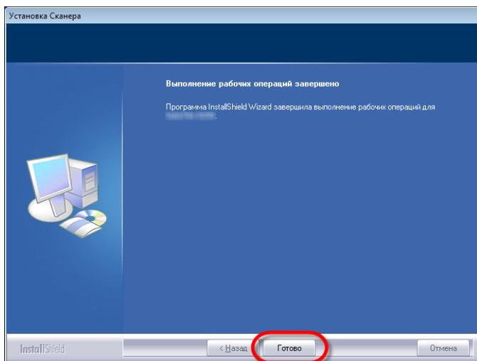
5. После установки программного обеспечения закройте все приложения и нажмите [Готово] для перезагрузки компьютера.
