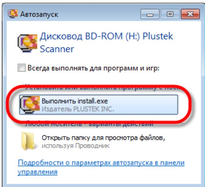
1. Вставьте диск, поставляемый со сканером в дисковод Вашего компьютера. В появившемся окне [Автозапуск] нажмите [Выполнить install.exe]. Если установка не началась автоматически, проверьте CD-ROM дисковод и вручную запустите файл [install.exe].
