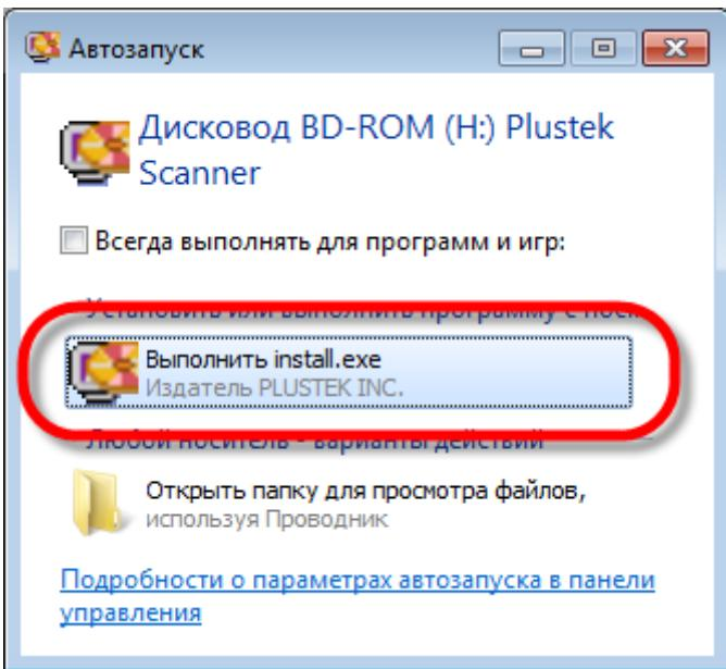
1. Вставьте CD-ROM, поставляемый со сканером. В появившемся окне [Автозапуск] нажмите [Выполнить install.exe]. Если установка не началась автоматически, проверьте CD-ROM дисковод и вручную запустите файл [install.exe]. Если появится [Контроль учетных записей пользователей] нажмите кнопку [Да]. Следуйте инструкции в появившемся сообщении по установке.
