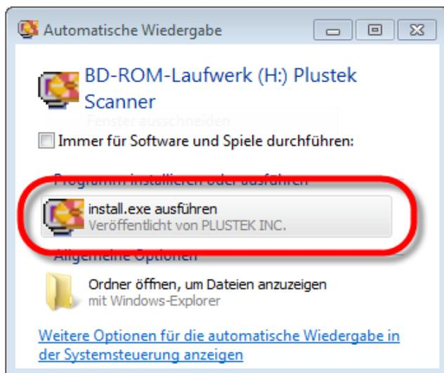
1. Legen Sie die mit ihrem Scanner mitgelieferte Setup-CD-ROM in das CD-ROM-Laufwerk ein. Klicken Sie im [Automatische Wiedergabe] Fenster auf [install.exe ausführen]. Wenn die Installation nicht automatisch startet, durchsuchen Sie ihr CD-ROM-Laufwerk und führen Sie manuell die Datei [install.exe] aus. Klicken Sie auf die Schaltfläche [Ja] falls der Dialog [Benutzerkontensteuerung] auftauchen sollte. Folgen Sie den Installationsanweisungen der Pop-up Nachricht.
