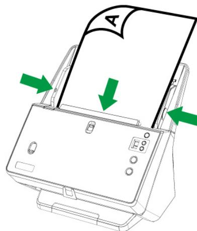
4. 扫描孔洞报表纸时，将导纸夹完全向外滑动以放入孔洞报表纸。按下固定按钮即可将导纸夹完全向外滑动。
