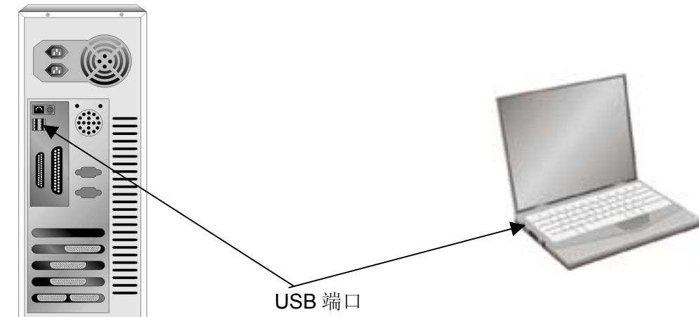
如果您的计算机上找不到此型 **USB** 端口，您必须购买一块合乎标准的 **USB** 适配卡，为计算机加装 **USB** 的端口。
