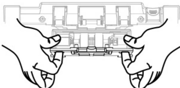
3. 将橡胶摩擦轮轴拉出拿下。 (如图中箭头所示方向)
