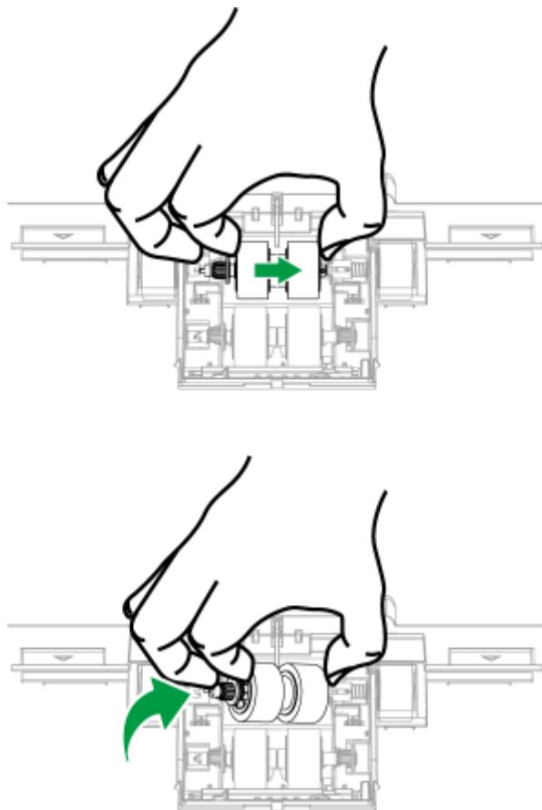
4. 安装新的取纸滚轮，将轮轴对准装在扫描仪的滚轮连接杆上（如图中箭头所示方向），即可换好新的滚轮。
