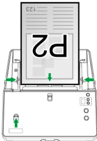
3. 根据导纸夹的宽度，轻推导纸夹使其正好与纸张接触即可。
