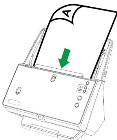
2. 可以打开纸张延伸板和出纸夹来固定文稿的位置，若有需要可放下出纸导板辅助整叠纸张输出的正确排序。
