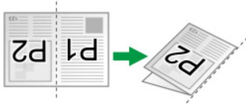
2. 将欲扫文件页顶端朝下且面朝下沿进纸匣的中央放置在 ADF 上，直至触及 ADF 底部。
