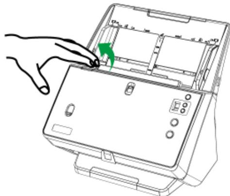
2. 打开轮盖前先将导纸夹完全向外滑动，接着打开轮盖。（如图中箭头所示方向）
