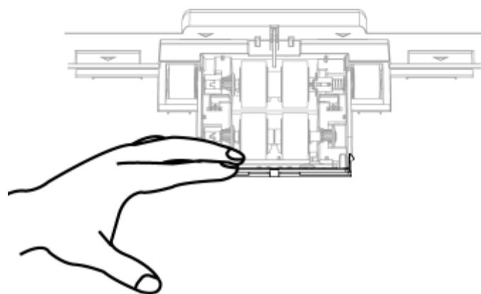
3. 将分纸轮轴拉出拿下。（如图中箭头所示方向）
