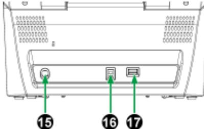
15. 电源连接接口—连接电源适配器。
