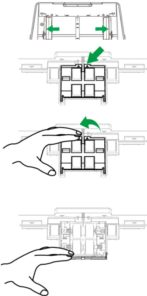
3. 将取纸轮轴拉出拿下。（如图中箭头所示方向）
