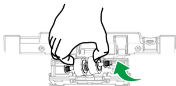
4. 安装新的橡胶摩擦滚轮，将轮轴对准装在扫描仪的轮轴连接杆上 (如图中箭头所示方向) ，即可换好新的滚轮。
