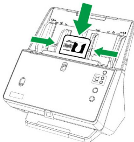
2. 调整导纸夹到卡片宽度，轻推导纸夹使其轻轻触碰卡片两边即可。
