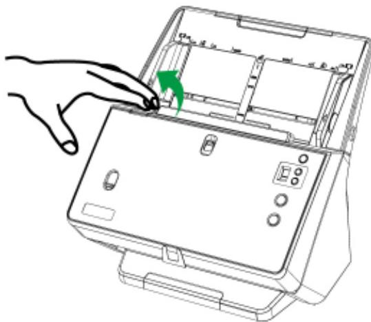
2. 打开橡胶摩擦轮盖。 (如图中箭头所示方向)
