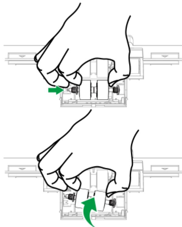
4. 安装新的分纸滚轮，将轮轴对准装在扫描仪的滚轮连接杆上（如图中箭头所示方向），即可换好新的滚轮。
