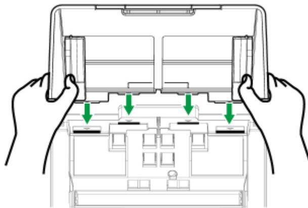
除非要将进纸夹卸下，否则请勿按下进纸匣两侧的卡榫开关。
