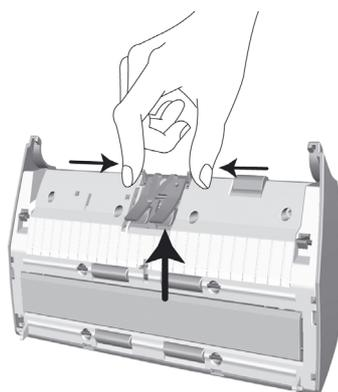
3. Feche a tampa ADF empurrando-a de volta para baixo até que ela se encaixe no lugar.
