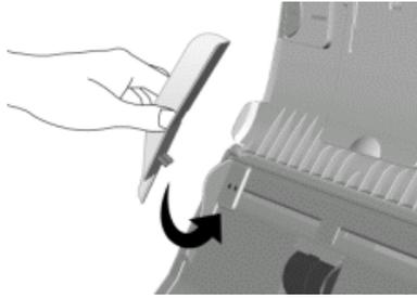
3. Feche a tampa do ADF empurrando o para baixo até que volta no encaixe.
