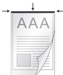
6. Carregue a folha de proteção no scanner, e alinhe a folha de proteção com a linha preta em direção ao centro do ADF.
