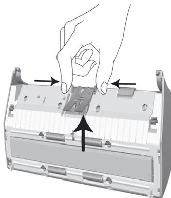
3. Instale o novo módulo do bloco inserindo os guias no módulo sobre as fendas deles no scanner.
