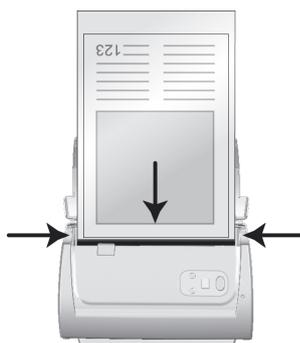
7. Para escaneamento de face simples, carregue a Folha da Proteção com a face voltada para baixo.
