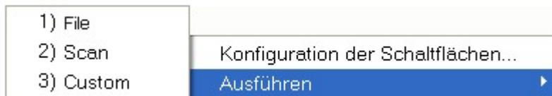
5. Das Dokument in dem Papiereinzug sollte jetzt in den ADF eingezogen und gescannt werden. Der Scanner startet sofort mit dem Scannen und führt die dazugehörige Aktion entsprechend der Einstellungen welche Sie in dem „Konfiguration der Schaltflächen“-Fenster festgelegt haben.
