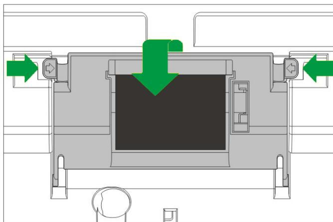
3. Entfernen Sie die Einzugs-Rolle, indem Sie die Rolle heraus ziehen.
