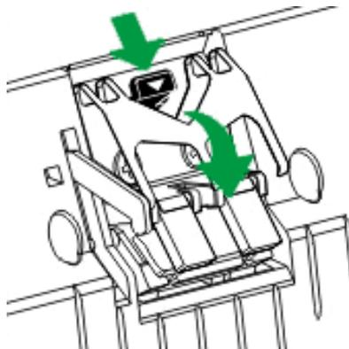
3. Installieren Sie das neue Pad-Modul indem Sie die Laschen in deren Führungen am Scanner schieben.
