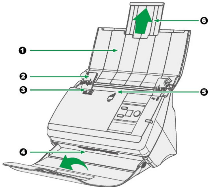
1. PAPIEREINFÜHRUNG—Hält das Papier zur Einführung. Öffnen Sie die Papiereinführung um den Scanner zu benutzen.
