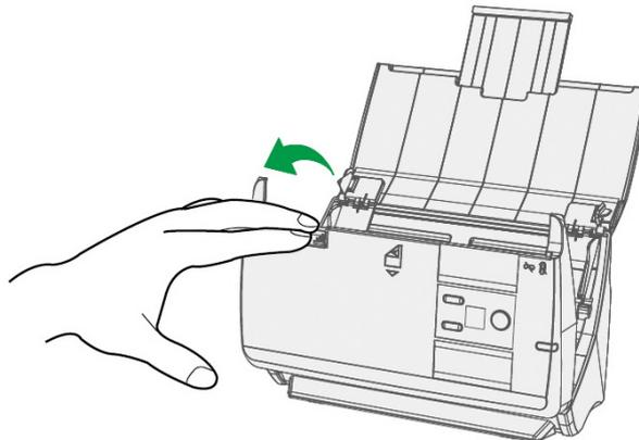
2. Entfernen Sie das Pad-Modul indem Sie den Öffnungshebel des Pad-Moduls drücken und das Pad-Modul herausziehen.
