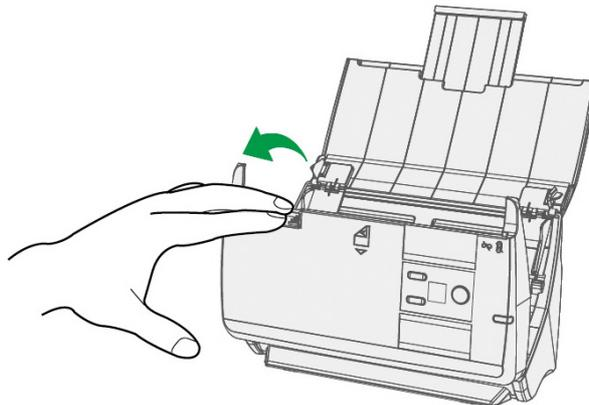
2. Öffnen Sie den Deckel der Einzugs-Rolle indem Sie beide Seiten des Deckels einklemmen.
