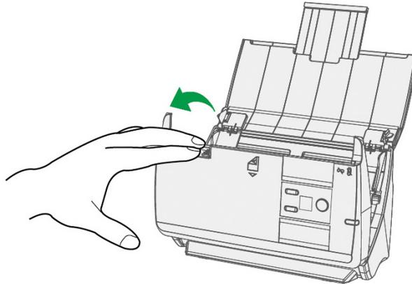
2. Wischen Sie sanft über die folgenden Flächen mit dem mit Reinigungsflüssigkeit (nur 95% Isopropyl Alkohol benutzen!) befeuchteten Tuch. Seien Sie vorsichtig damit Sie NICHT die Oberflächen zerkratzen.
