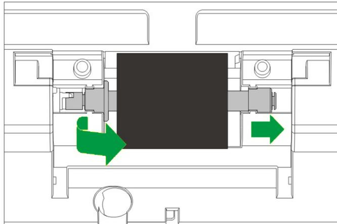
4. Installieren Sie eine neue Einzugs-Rolle, indem Sie diese auf die Rollerlenkung des Scanners einpassen und einlegen.
