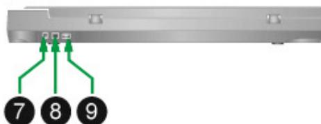
7. RECEPTEUR DE COURANT— Connexion du scanner à un transformateur standard comme celui fourni.
