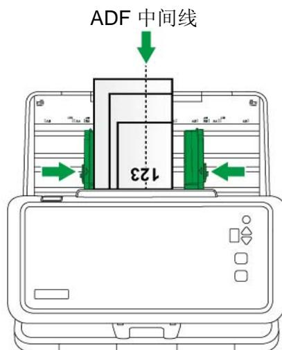
2. 您可以根据需要将**右侧**的导纸夹分为对称导纸夹和不对称导纸夹。
