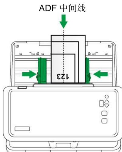
2. 您可以根据需要将左侧的导纸夹分为对称导纸夹和不对称导纸夹。
