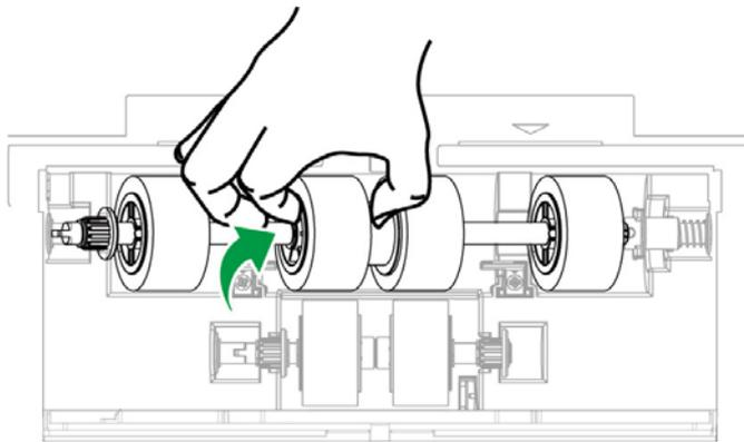
4. 安装新的取纸滚轮，将轮轴对准装在扫描仪的滚轮连接杆上（如图中箭头所示方向），即可换好新的滚轮。
