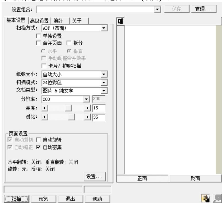
4. 调整扫描设置。对于“ADF(双面)”扫描，您可以对文件的正面和反面分别进行扫描设置。点击“正面”按钮调整文件正面的扫描设置，然后点击“反面”按钮调整文件反面的扫描设置。
