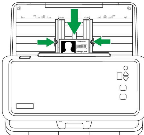
2. 调整导纸夹到卡片宽度，轻推导纸夹使其轻轻触碰卡片两边即可。
