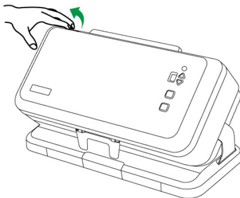
2. 安装进纸夹，将进纸夹的卡脚对齐并装入扫描仪机身上对应的插孔中。
