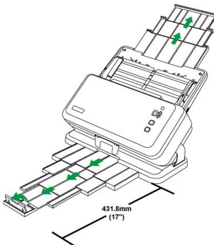
7. 出纸挡板—防止弹出的纸张从延伸出纸夹掉落。
