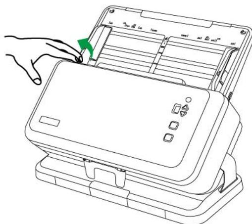
2. 打开轮盖前先将导纸夹完全向外滑动，接着打开轮盖。（如图中箭头所示方向）
