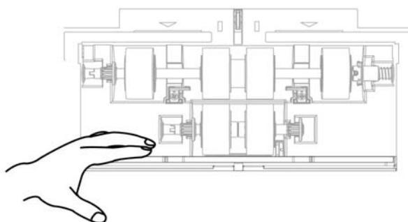
3. 将分纸轮轴拉出拿下。（如图中箭头所示方向）
