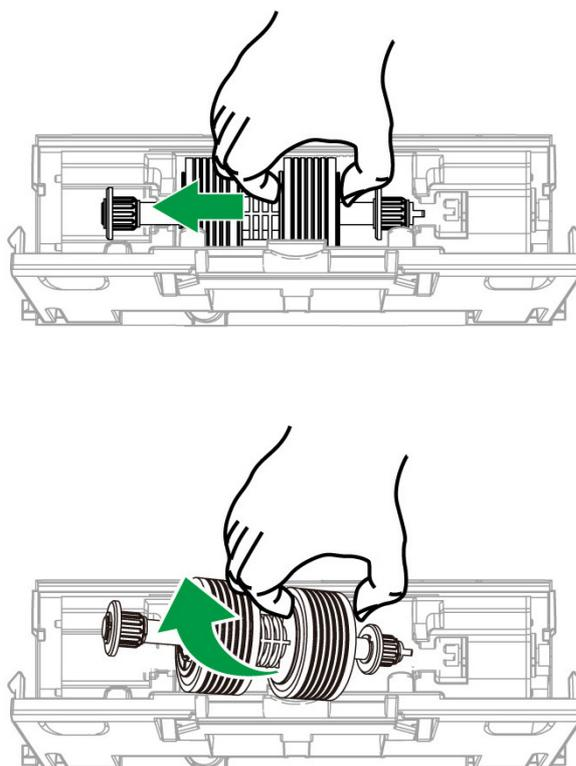
4. 安装新的橡胶摩擦滚轮，将轮轴对准装在扫描仪的轮轴连接杆上（如图中箭头所示方向），即可换好新的滚轮。
