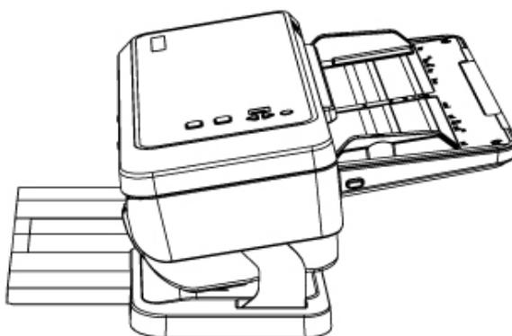
2. 将欲扫文件页顶端朝下且面朝下沿进纸匣的中央放置在 ADF 上，直至触及 ADF 底部。
