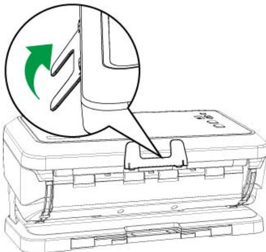
5. 出纸夹—防止纸张掉落遗失,辅助扫描后文件整齐堆栈。
