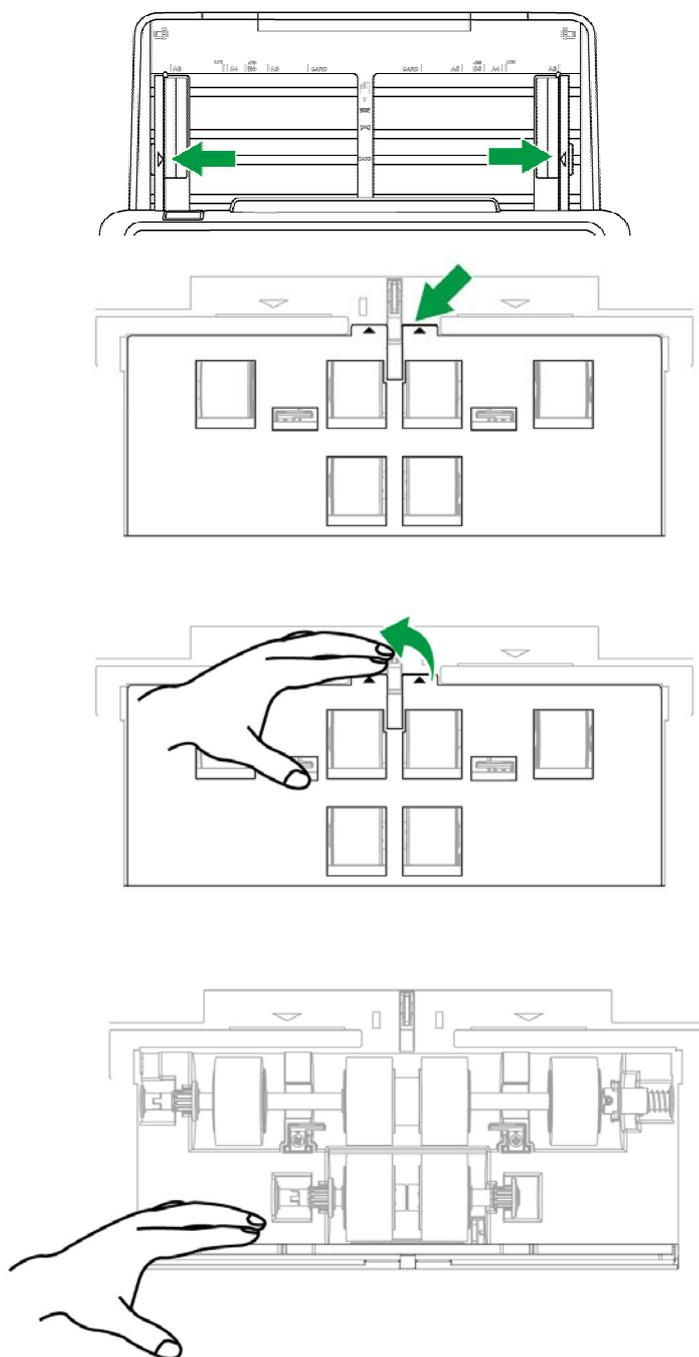
3. 将取纸轮轴拉出拿下。（如图中箭头所示方向）
