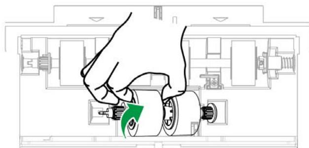
4. 安装新的分纸滚轮，将轮轴对准装在扫描仪的滚轮连接杆上（如图中箭头所示方向），即可换好新的滚轮。
