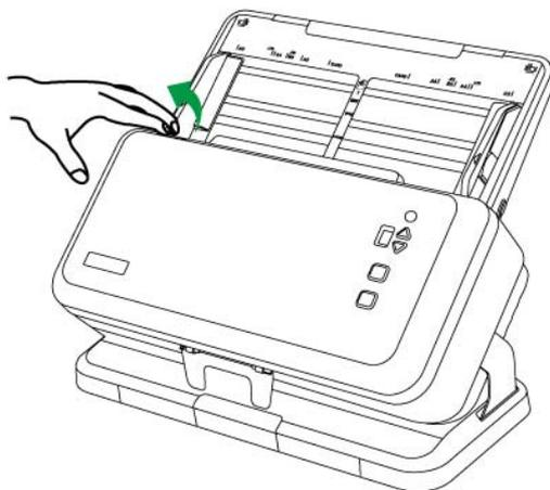
2. 打开橡胶摩擦轮盖。（如图中箭头所示方向）
