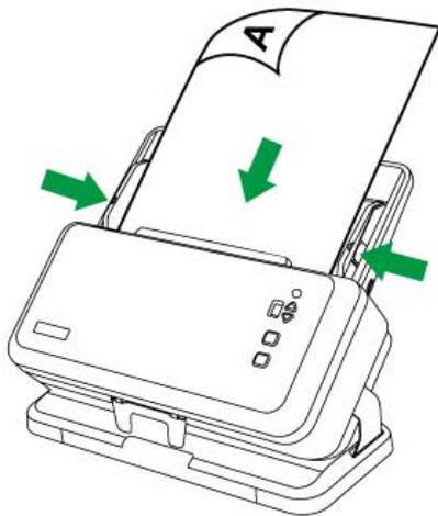
2. 可以打开纸张延伸板和延伸出纸夹来固定文稿的位置，若有需要可放下出纸导板辅助整叠纸张输出的正确排序。
